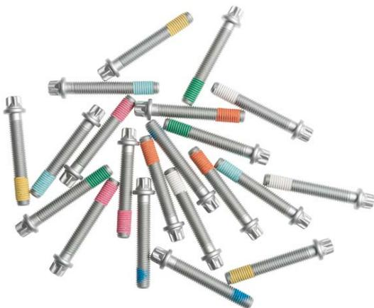
Die unterschiedlichen Gewindegewissungssysteme werden als Vorbeschichtung mit klebender, klemmender oder dichtender Funktion partiell auf die Gewinde appliziert, um sie unter anderem gegen Losdrehen, Verlieren oder dichtend zu sichern.
