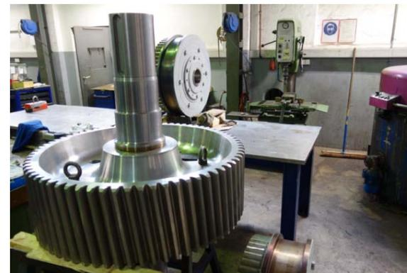
Bild 11: Montage einer Antriebswelle
