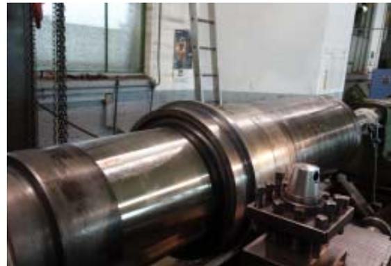
Bild 4-6: Fertigdrehen auf Maß nach dem Laserauftragschweißen
