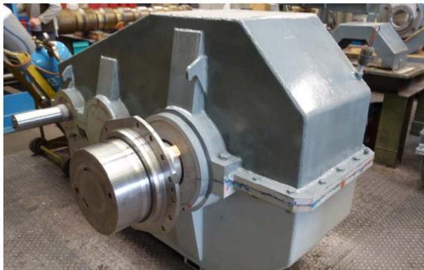
Bild 10: Komplett instandgesetztes Getriebe
