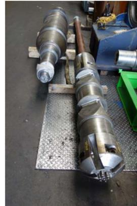
Bild 15: Spreizdorn nach Instandsetzung eines Lagers
