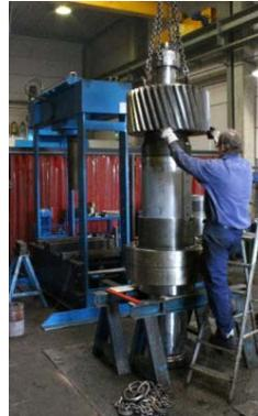
Bild 8: Montage der Richtachse
