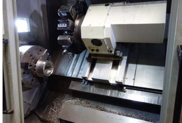
Bild 13: Fertigung von Drehteilen aus hochlegiertem Edelstahl
