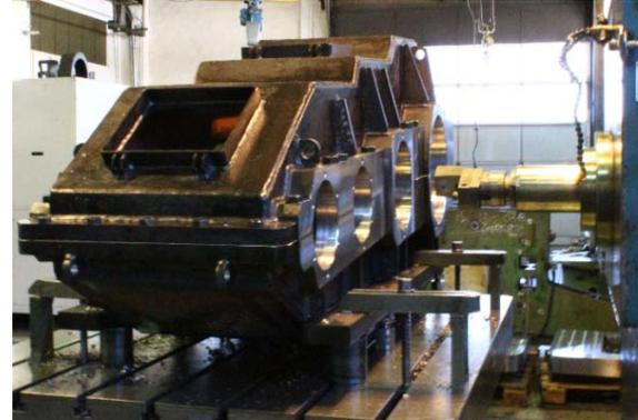
Bild 9: Bohrwerksbearbeitung eines Getriebegehäuses bei Schmidtke & Sohn
