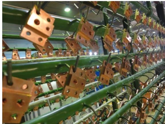
Bild 9: Kupfer-Bauteile auf dem Weg in die Bäderstraße zum chemischen Vernickeln.
