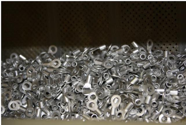
Bild 8: Trommelware: Kabelschuhe aus Kupfer für die Luft- und Raumfahrtindustrie erhalten eine Chemisch Nickel-Legierung zum Schutz vor Korrosion.
