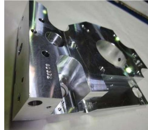
Bild 12: Format zeigt Chemisch Nickel bei Komponenten mit zahlreichen Zwischenwänden, innenliegenden Bohrungen, Passungen und Gewinden.
