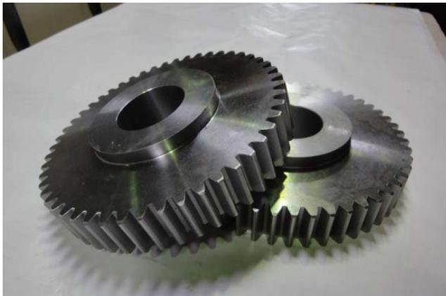
Bild 13: Insbesondere zur technischen Beschichtung von Bauteilen mit vielen Ecken und Kanten ist Chemisch Nickel unverzichtbar.
