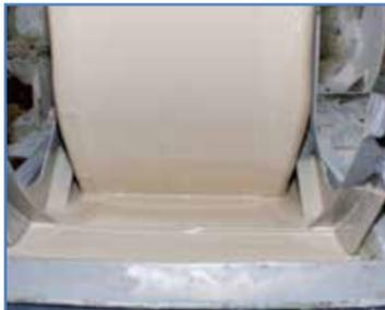
Fest-Flüssigtrennung durch vollautomatische Filtertrommel
