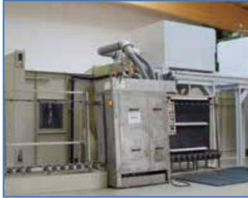
Automatische Anlage zur Flachglasätzung
